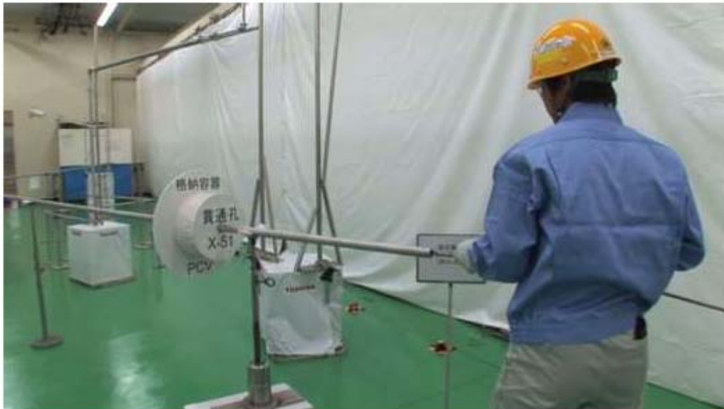
شکل ۶. یکی از کارکنان در حال انجام تست مدل برای وارد کردن یک ترمومتر جدید در یونیت ۲
