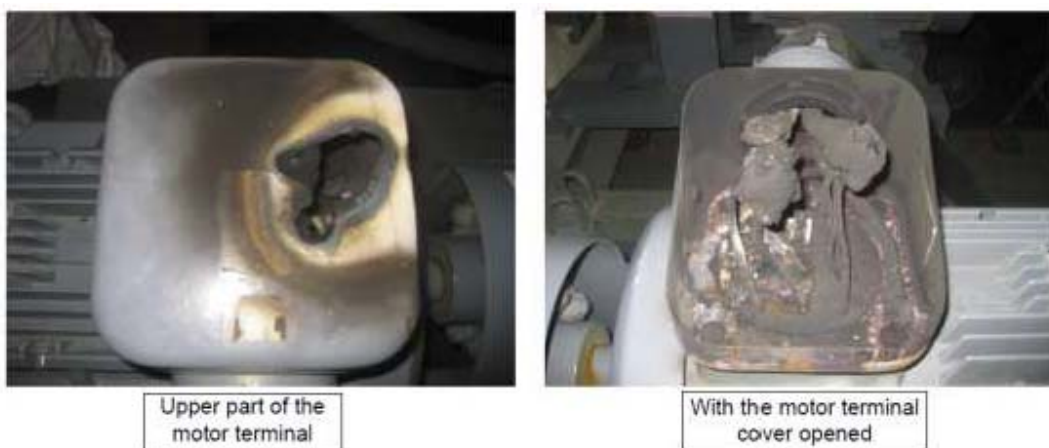
شکل ۱۶. نمای نزدیک اثر سوختگی روی ترمینال موتور
