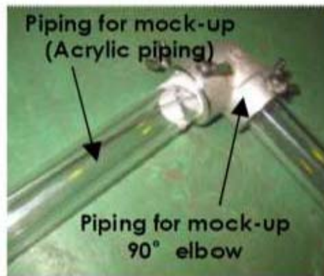
شکل ۱. تست مدل به اندازه طبیعی و کامل برای مطالعه و آزمایش وارد کردن نومومتر جدید در یونیت ۲ از طریق لوله‌های موجود
