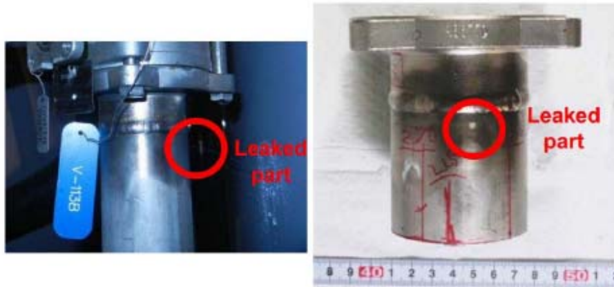
شکل ۲۱. قسمتی از سیستم SARRY که برای آزمون مخرب خارج شده است
