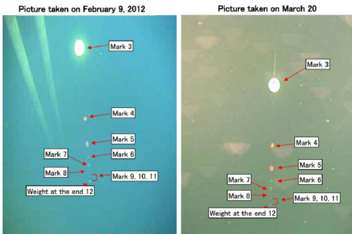
شکل ۱۷. میدان دید در حوضچه سوخت مصرف شده یونیت ۴ در ماه‌های فوریه و مارس
