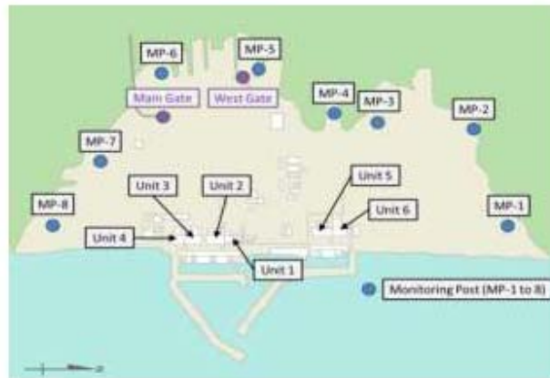
شکل ۲۵. ایستگاه‌های پایش داخل سایت در فوکوشیما دایچی
