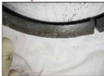
شکل ۱۱. چرخ دنده صدمه دیده جرثقیل در حوضچه مشترک سوخت مصرف شده
