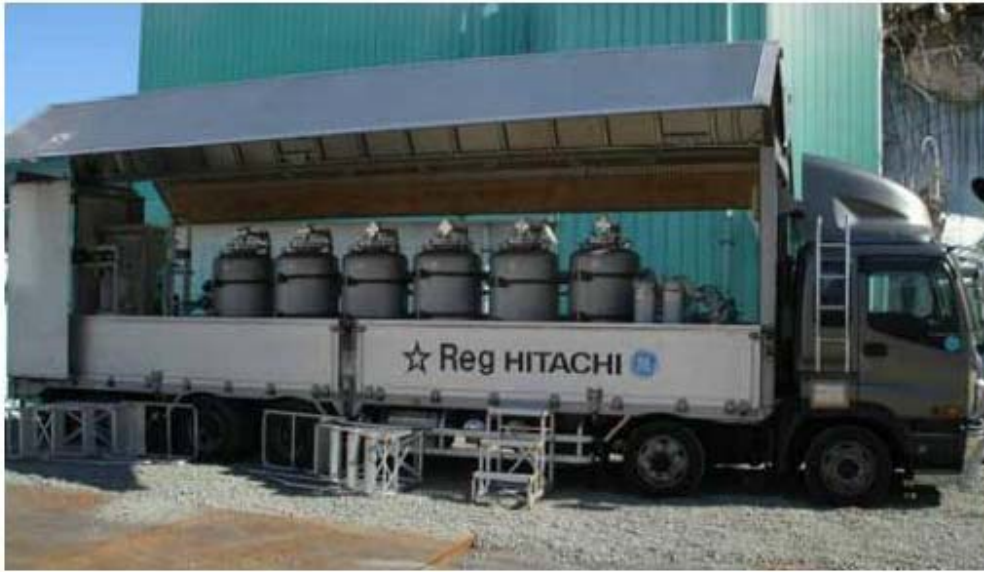
شکل ۴. فرآیند تبادل یونی که روی یک کامیون قرار دارد
