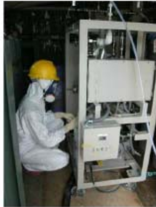
شکل ۲. یکی از کارکنان و دستگاه نمونه برداری در طبقه اول مخزن پوشش اولیه (PCV) یونیت ۲
