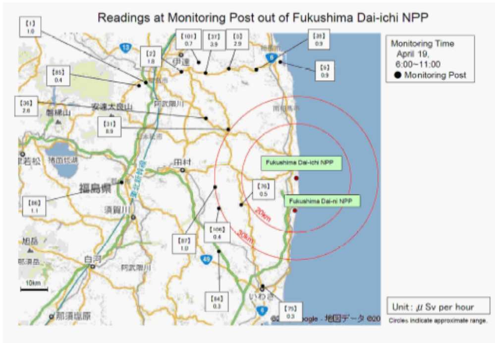
شکل ۱۰. اطلاعات ایستگاه‌های پایش در خارج از نیروگاه هسته‌ای فوکوشیما دایچی
