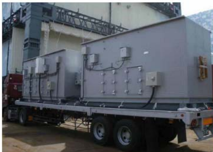
شکل ۴. فیلتر هوای پوشش ساختمان راکتور یونیت ۱
